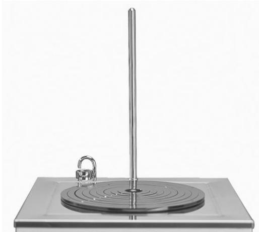
Pied de trépied, en inox anti-rouille, pour une fixation sûre des cuves d'évaporation. Faire tourner le pied de trépied dans le sens des aiguilles d'une montre, qui s'insère dans une ouverture à l'arrière de la bordure du bain d'évaporation, permet de le fixer.
